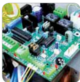
ELPRO 35M programmatore per il master. ELPRO 35S è la scheda montata sulla versione slave
