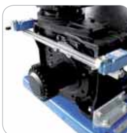
Ingranaggio di trascinamento e finecorsa meccanici
